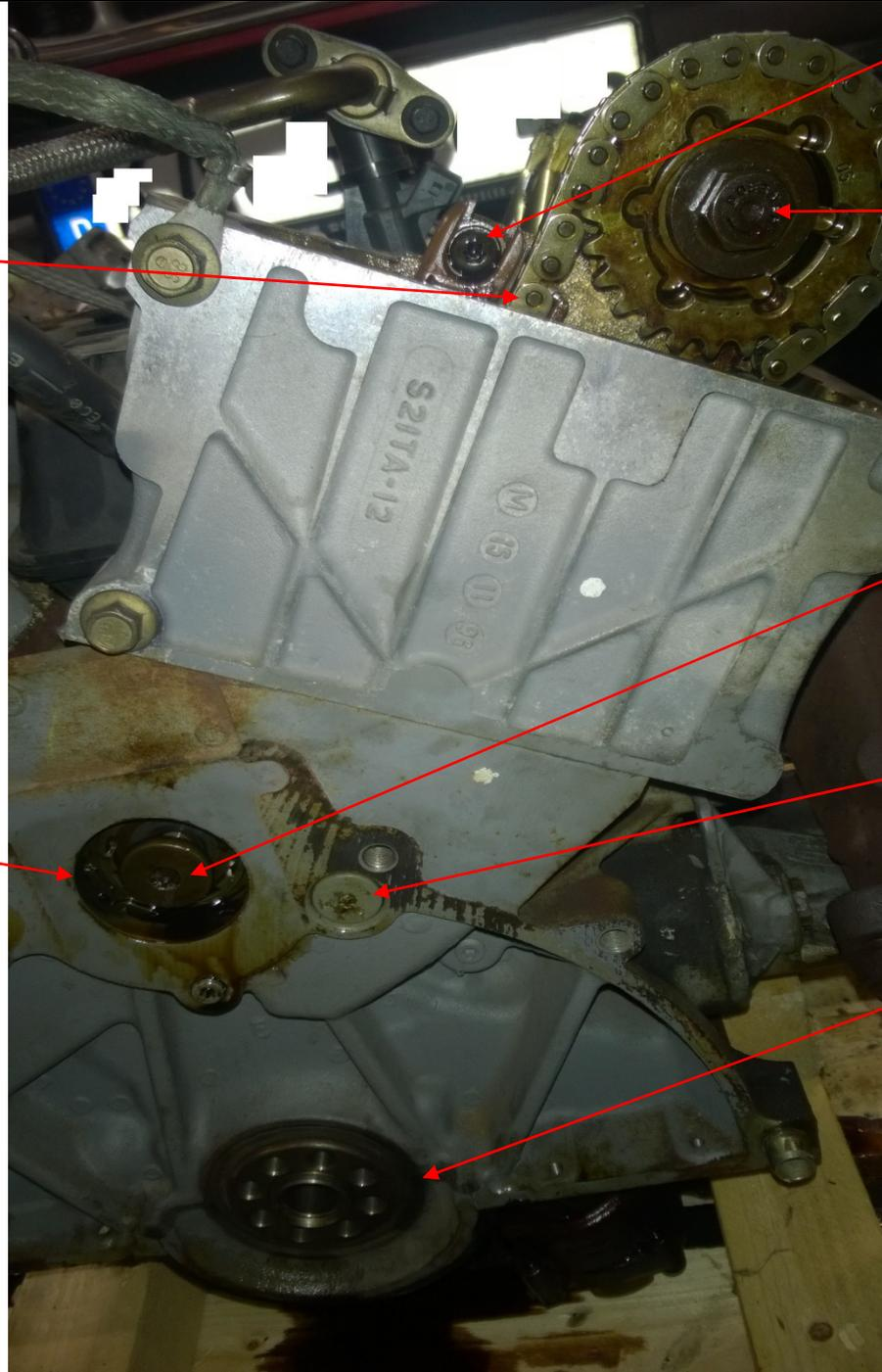
Wenn diese Schraube beschädigt ist muss sie bei Ford bestellt werden. Ist bei Rover nicht erhältlich. Geht bei Rover durch den Ventildeckel.
